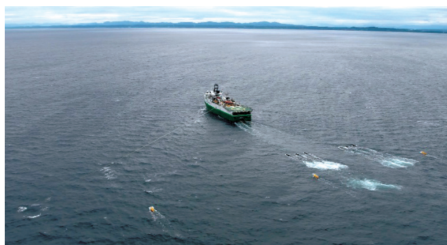
船舶による弾性波探査の様子
